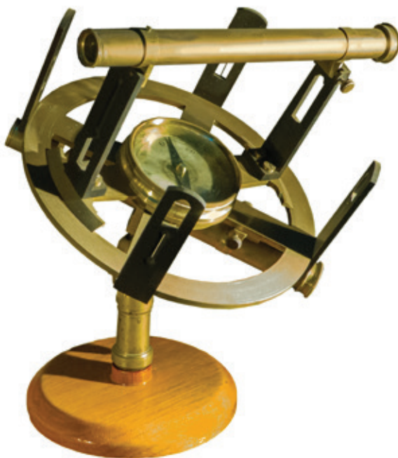
8.5 Hollandse Cirkel met richtkijker en nonius zoals te zien in het GeoFort in Herwijnen. Kees Molders, Culemborg
