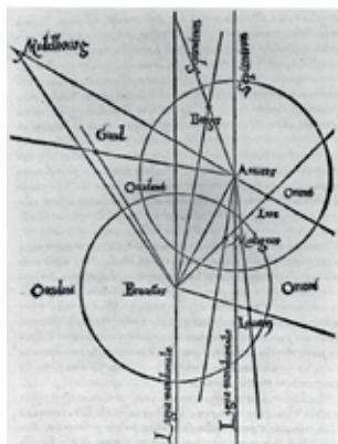
In 1533 beschreef Gemma Frisius de eerste beginselen van de driehoeksmeting. Op de tekening zie je hoe de eigenschappen van driehoeken gebruikt werden om de afstanden tussen plaatsen te bepalen. Wikimedia Commons
