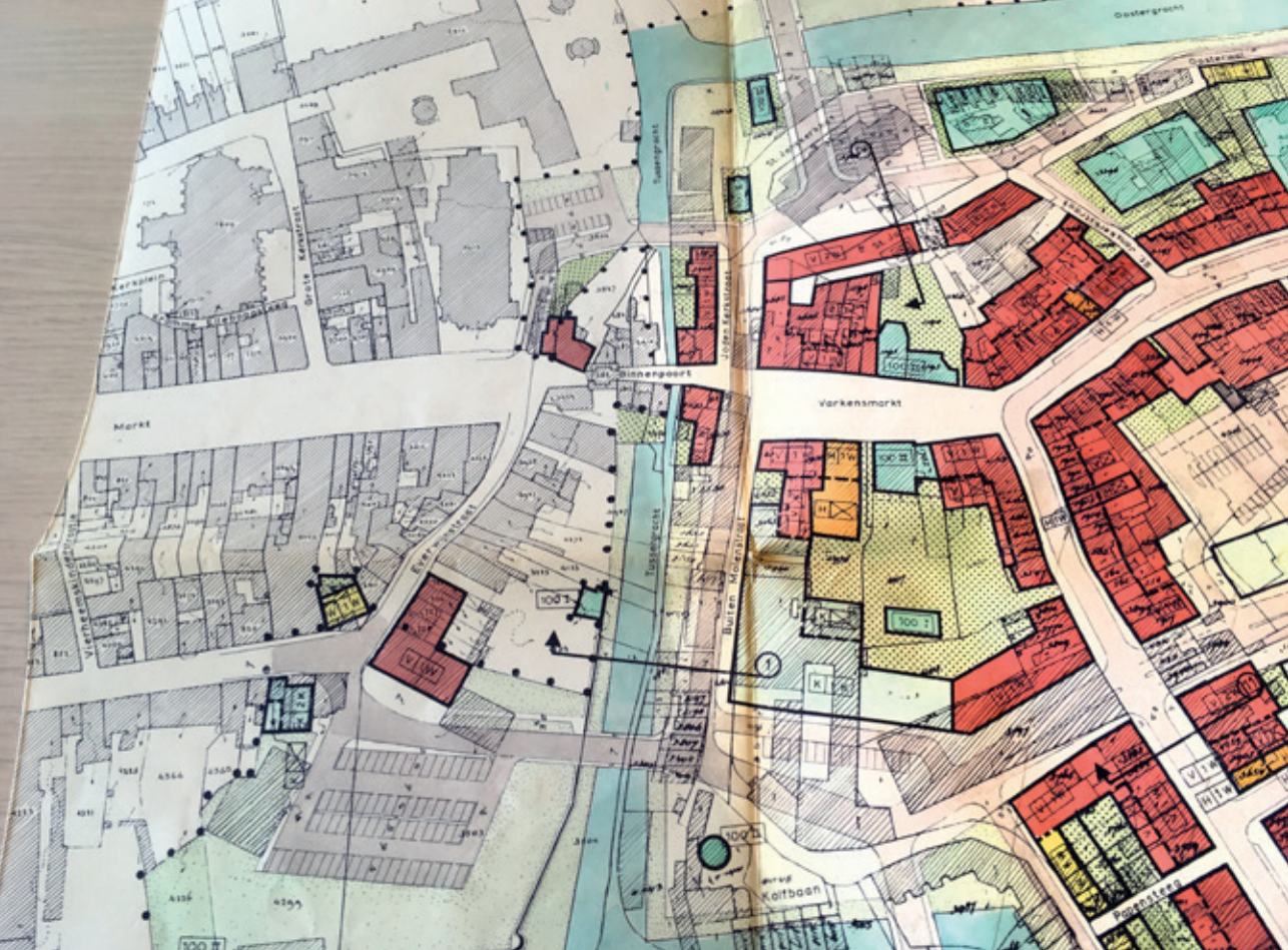
De geplande doorbraken met de te slopen bebouwing. Regionaal Archief Rivierenland, Tiel
