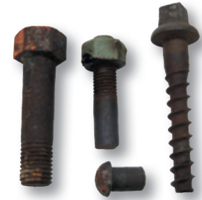
Voorbeelden van het in de oude brug gebruikte ijzerwerk dat de brug 114 jaar lang zonder noemenswaardige problemen bij elkaar hield. De schroef rechts is gebruikt om de rail op de eiken biels te bevestigen. (Elisabeth Weeshuismuseum, Culemborg)
