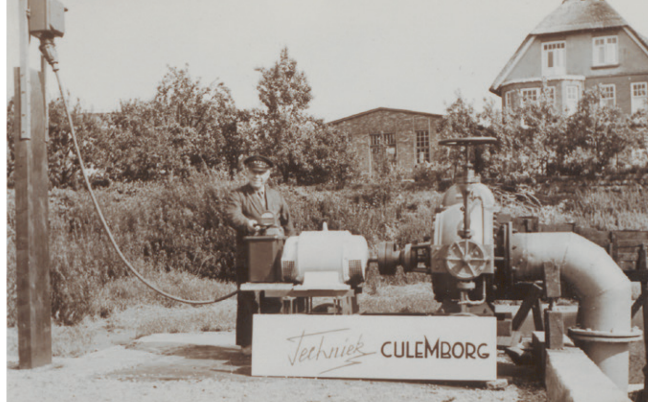
Elektrische pomp, geleverd door de firma Techniek van Wouter Blijenberg, waarmee water uit de haven via ‘bakken’ in de grachten werd gebracht. Havenmeester Jo van Tienhoven staat er tevreden naast.
