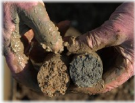
Afbeelding 18. Boorsel van Hoek in de volkstuinten. Links mooie klei. Rechts mengsel van klei en veenresten.
